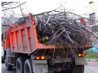
Рисунок 1 – Загрузка кузова неподготовленными древесно-растительными отходами (низкая плотность укладки)
