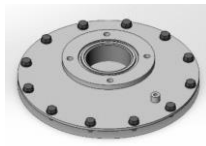
Рисунок 2 – Второе исполнение сборочного узла «Установка заглушки»
