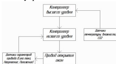
Рисунок 1 – Структурная система управления климат-контролем теплицы
