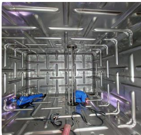
Рисунок 1 – Тестовый резервуар хранения СПГ
