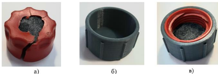
Рисунок 1 – Крышка с четырехзаходной резьбой: а – крышка разрушенная; б – корпус без резьбы, распечатанный на 3D-принтере; в – крышка восстановленная
