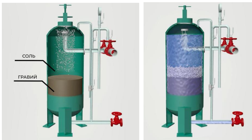
Рис. 1. 3D-модель солерастворителя водоподготовительной установки
