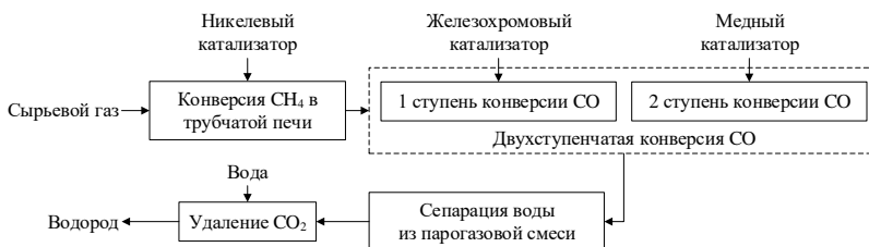
Рисунок 1 – Функциональная схема ПКМ для модели УПКМ в составе ТЭЦ: CH 4 – метан; CO – оксид углерода; CO 2 – углекислый газ.
