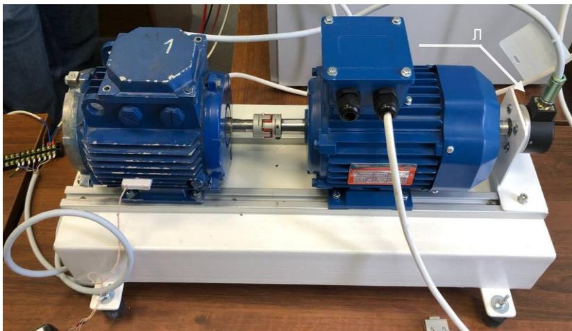
Рис.1. Асинхронные электродвигатели - Исследуемый АИР71А6 и нагрузочный 5АИ71В6
