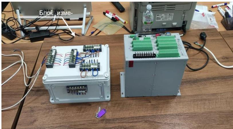
Рис.3. Измерительный блок и блок терминала РЗиА МИР100
