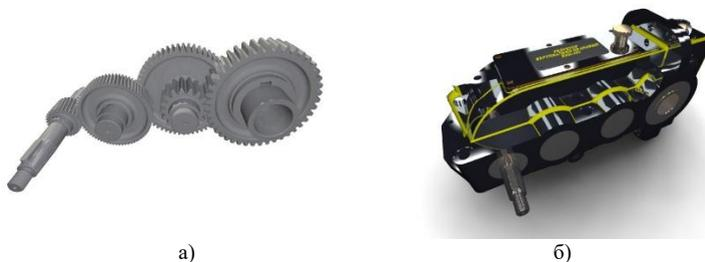
Рис. 1. Некоторые этапы проектирования редуктора ВКН-280: а – валы механической передачи; б – трехмерная сборка
