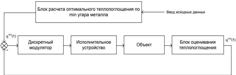
Рис. 1. Двухуровневая система управления нагревом металла
