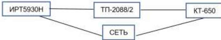
Рис. 1. Схема испытаний термопары и вторичного прибора
