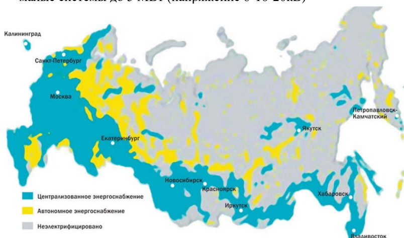
Рис.1. Зонирование территории России по степени централизации электроснабжения [2]
