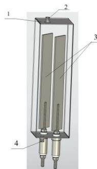
Рис. 1. Устройство для получения пара: 1- Внутренний корпус; 2- Пароотводящий патрубок; 3- Электроды; 4- Патрубок подвода СОТС.
