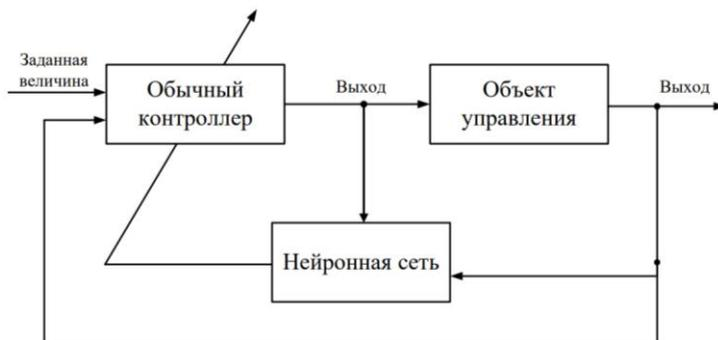
Рисунок 1 Схема нейронного управления с самонастройкой.
