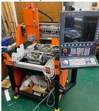
Рис. 1. Станок Cutter GT с ЧПУ IntNC Pro
