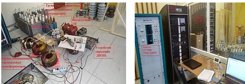
Рис. 2. Схема испытания трансформатора напряжения
