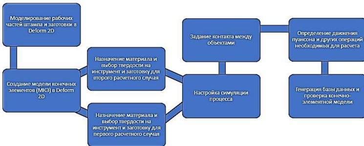
Рис. 1. Алгоритм выполнения работы в среде численного моделирования
