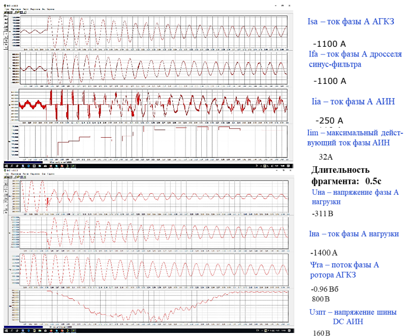
Рис. 1. Временные диаграммы АСЭ в режиме КЗ фазы А нагрузки
