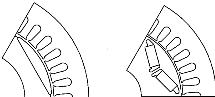
Рис. 2. Магнитная система генератора с магнитоэлектрическим возбуждением
