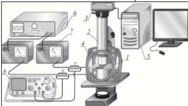
Рис. 1. Схематическое изображение установки для оптических наблюдений: 1 – образец магнитного коллоида, 2 – микроскоп, 3 – цифровая фотокамера, 4 – катушки Гельмгольца, 5 – компьютер, 6 – генератор, 7 – усилитель, 8 – осциллограф
