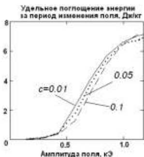
Рис. 4. Концентрация частиц в суспензии, c , слабо влияет на поглощение энергии поля
