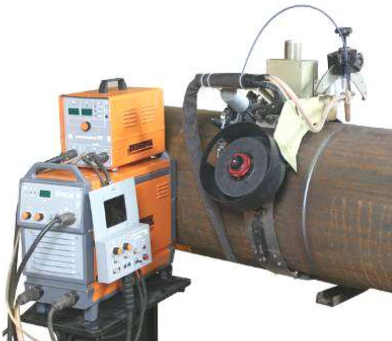
Рис. 2. Общий вид установки УАСТ-1 для орбитальной сварки неповоротных стыков труб плавящимся электродом
