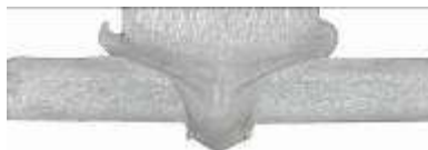
Рис. 2. Имитация заваренного дефекта в пластине сплава 1420 сваркой трением вращающейся расходуемой вставкой
