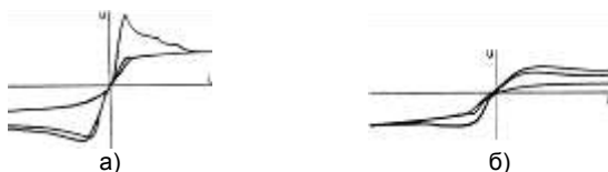
Рис. 1. Вольт-амперные характеристики сварочной дуги: а – синусоидальный источник питания; б – нелинейный источник питания
