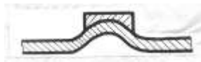
Рис. 2. Схема поперечного сечения ребра со сформированным покрытием вращающимся электродом из сплава ВЖЛ2 (ВЖЛ2М)
