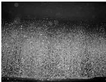
Рис. 1. Пример фотоснимка картины струеобразования в верхнем отсеке деаэрационной колонки ДА-300м при расходе воды 170 м<sup>3</sup>/ч
