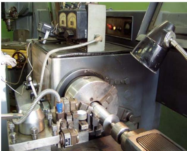
Рис. 4. Фотография экспериментальной установки для исследования деталей на износостойкость
