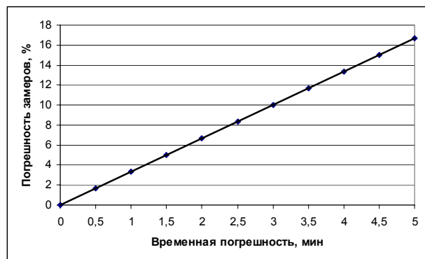
График изменения погрешности измерений от временной погрешности \Delta t_* при длительности периода измерений t_\Pi = 0,5 ч
