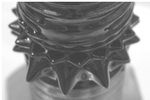
Рис. 1. Поверхность болта с магнитной жидкостью
