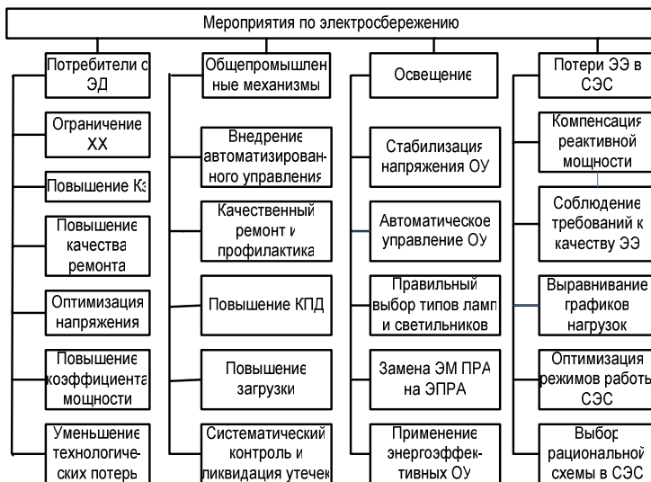
Рис. 2. Мероприятия по электросбережению на энергетических объектах
