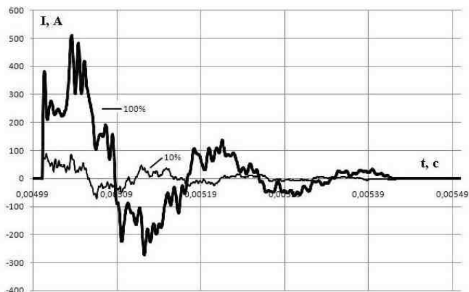
Рис. 5. Токи переходного процесса при ОЗЗ в точках \alpha = 10\% и \alpha = 100\% обмотки статора генератора типа ТВВ-320-2
