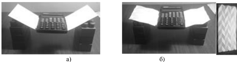
Рис. 1. Экспериментальное исследование значения ребер жесткости; а – значительный прогиб листа бумаги под предметом; б – эффект ребра жесткости для уменьшения прогиба листа бумаги под тяжестью предмета
