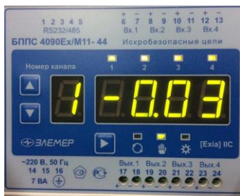
Рис. 1. Дисплей БППС при симуляции сигнала 4 мА
