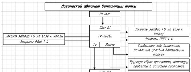
Рис. 1. Фрагмент алгоритма ФГУ вентиляции топки
