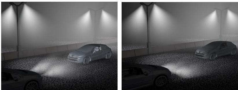
Рис. 1. Распространение светового потока при различных вариантах регулирования фар
