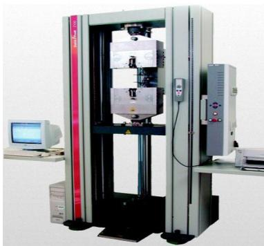
Рис. 1. Испытательная машина Zwick/Roell Z 150
