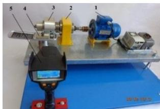
Рис. 1. Фотография экспериментальной установки: 1 – двигатель; 2 – стойка; 3 – корпус; 4 – весы; 5 – тепловизор.
