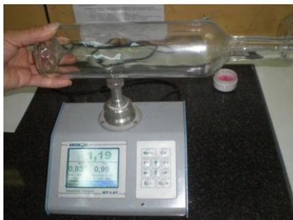
Рис.2. Контроль толщины стенки тары
