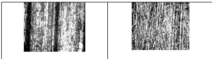
Рис.2. Поверхность стали 40X13 (вид сверху): а) – после точения; б) –после точения и алмазного выглаживания (ув.× 2500)
