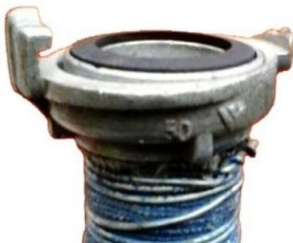
Рис.1. Скол запорных выступов соединительной головки пожарного рукава
