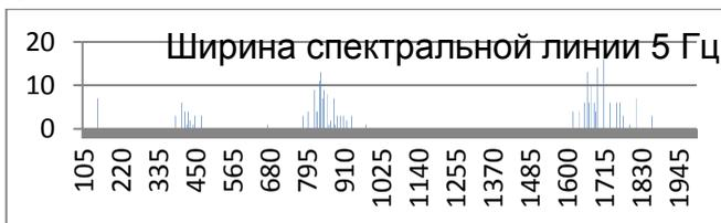
Рис. 2. Распределение информативных частот в СЧ диапазоне зубчатой передачи
