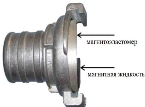
Рис. 1. Схема нанесения магнитной жидкости
