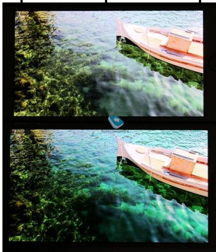
Рис. 3 - Сравнение IPS(сверху) и Super AMOLED (снизу)
