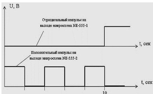
Рис. 2. График, поясняющий принцип работы устройства
