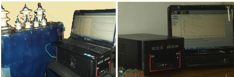
Рис. 1. Устройство диагностики электрической изоляции
