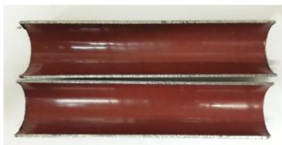
Рисунок 1 - Теплообменная трубка с нанесенным защитным покрытием
