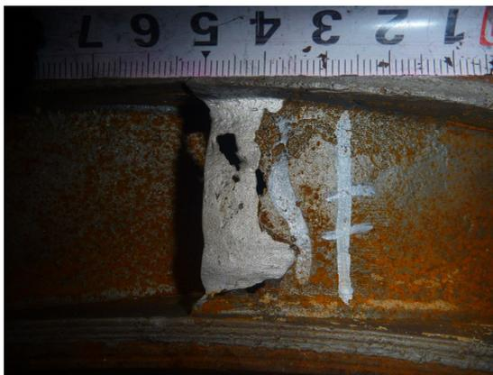
Рисунок 1. Сквозной дефект лопатки
