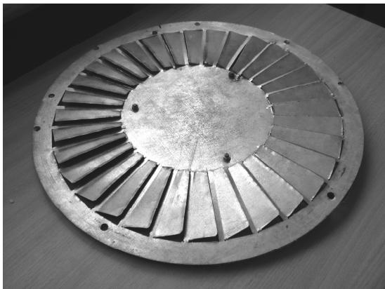
Рис. 1. Газораспределительная решётка (вид снизу)
