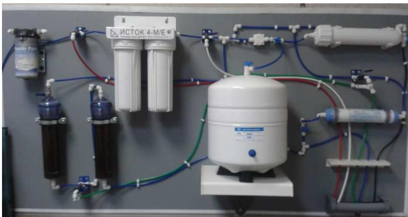
Рис 1. Стенд "Установка обратного осмоса и химического обессоливания"
