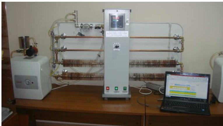
Рис. 1. Лабораторный стенд "Определение коэффициента теплопередачи через гладкую и оребренную трубы"
