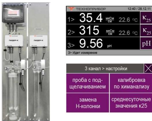
Рис. 1. Внешний вид и экранные формы анализатора примесей теплоносителя «Лидер»
