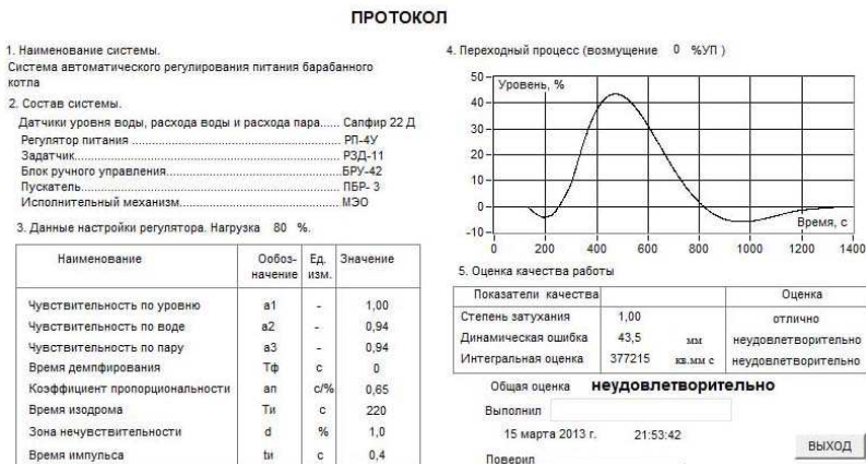
Рис. 2. Работа трехимпульсного РП при возмущении нагрузкой (расчет ПИ-регулятора для одноконтурной АСР)
