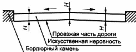
Рис. 2. Профиль при двустороннем поперечном уклоне проезжей части и наличии дождеприемных колодцев с верхней стороны дороги на спуске у ИН
