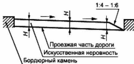
Рис. 3. Профиль при одностороннем поперечном уклоне проезжей части и отсутствии дождеприемного колодца в нижней лотке с верхней стороны дороги на спуске у ИН
