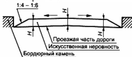
Рис. 1. Профиль при двустороннем поперечном уклоне проезжей части и отсутствии дождеприемных колодцев с верхней стороны дороги на спуске у ИН
