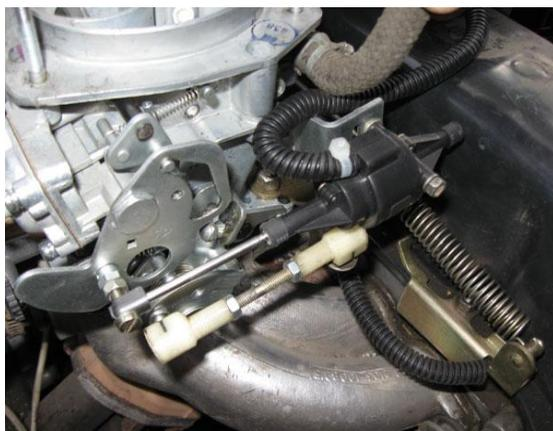
**Рис. 1. Положение шагового двигателя (моторредуктора) относительно карбюратора и его монтаж на «лапку» воздушной заслонки.**
