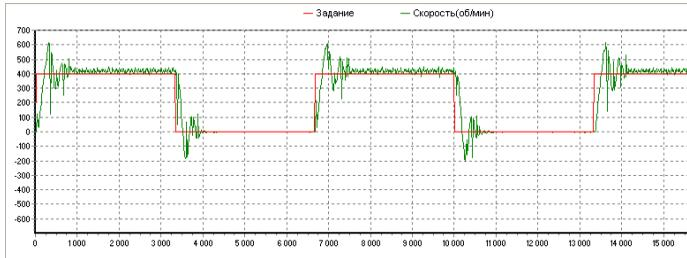
Рис. 1. Отработка импульсного сигнала с частотой 0,15 Гц и амплитудой 400 об/мин при  $S=50 \text{ (об/мин)/с}$
