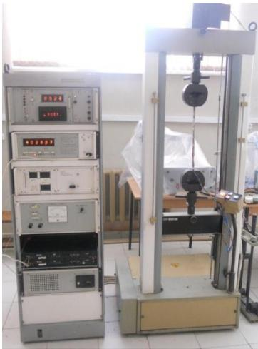
Рис.1. Испытательная машина IP5057-50
