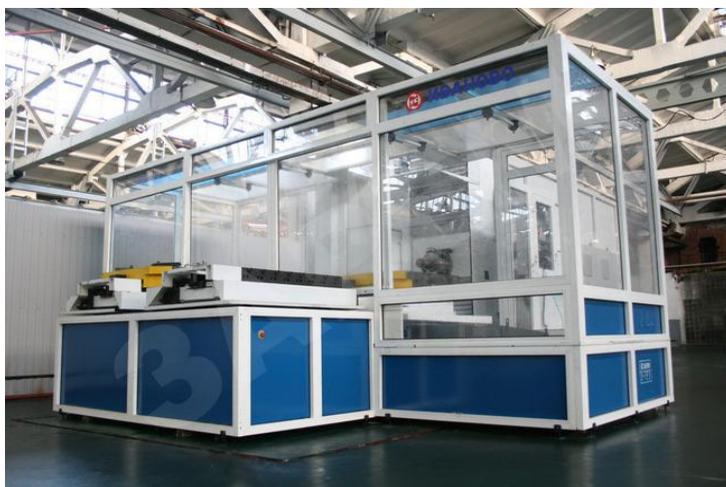
1700Нм, мощностью 30кВт, высокой скоростью установочных перемещений 20 м/мин. Подача СОЖ осуществляется как внешним поливом, так и через шпиндель под давлением до 5МПа.
