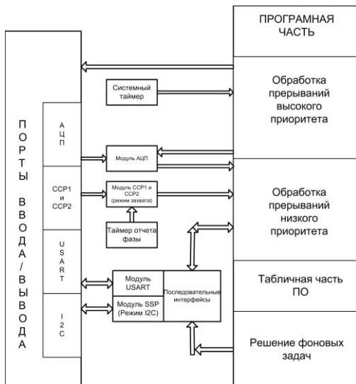
Рис. 1. Функциональная схема бездатчикового ВПД
