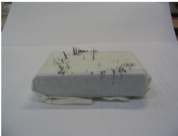
Рис. 4. Визуализация магнитного поля с помощью стальных опилок
