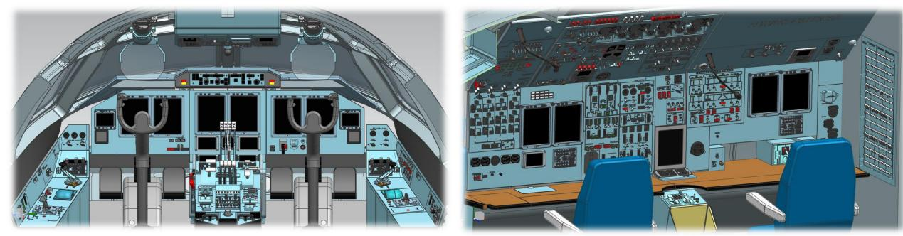
Разработка КД на натурный макет кабины экипажа самолета Ан-124-100М(ВТА)
