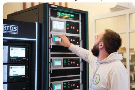
инструментальную и методическую погрешность проведения эксперимента. В лаборатории установлено современное оборудование, в том числе программно-инструментальный комплекс моделирования RTDS, на котором по этому гранту и другим НИР, занимаются аспиранты кафедры АУЭС. Например, Алексей Петров является ответственным за совместную работу RTDS и другого испытательного оборудования.
