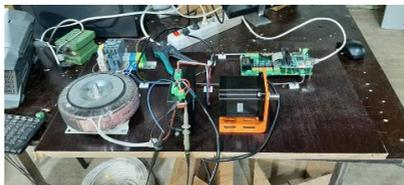
Рис. 1. Испытательный стенд для шагового двигателя
