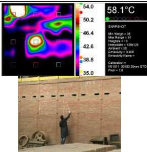
Рис. Результаты тепловизионного обследования стенки печи
