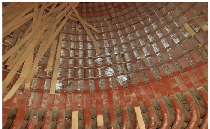
Рис. 1.4. Повреждение обмотки статора АД на Рязанской ГРЭС из-за повреждения ОР
