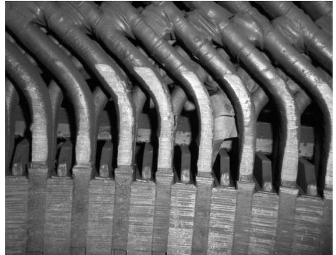
Рис. 1.2. Повреждение обмотки статора АД АНЗ-4-16-45-10 из-за обрыва стержней ОР
