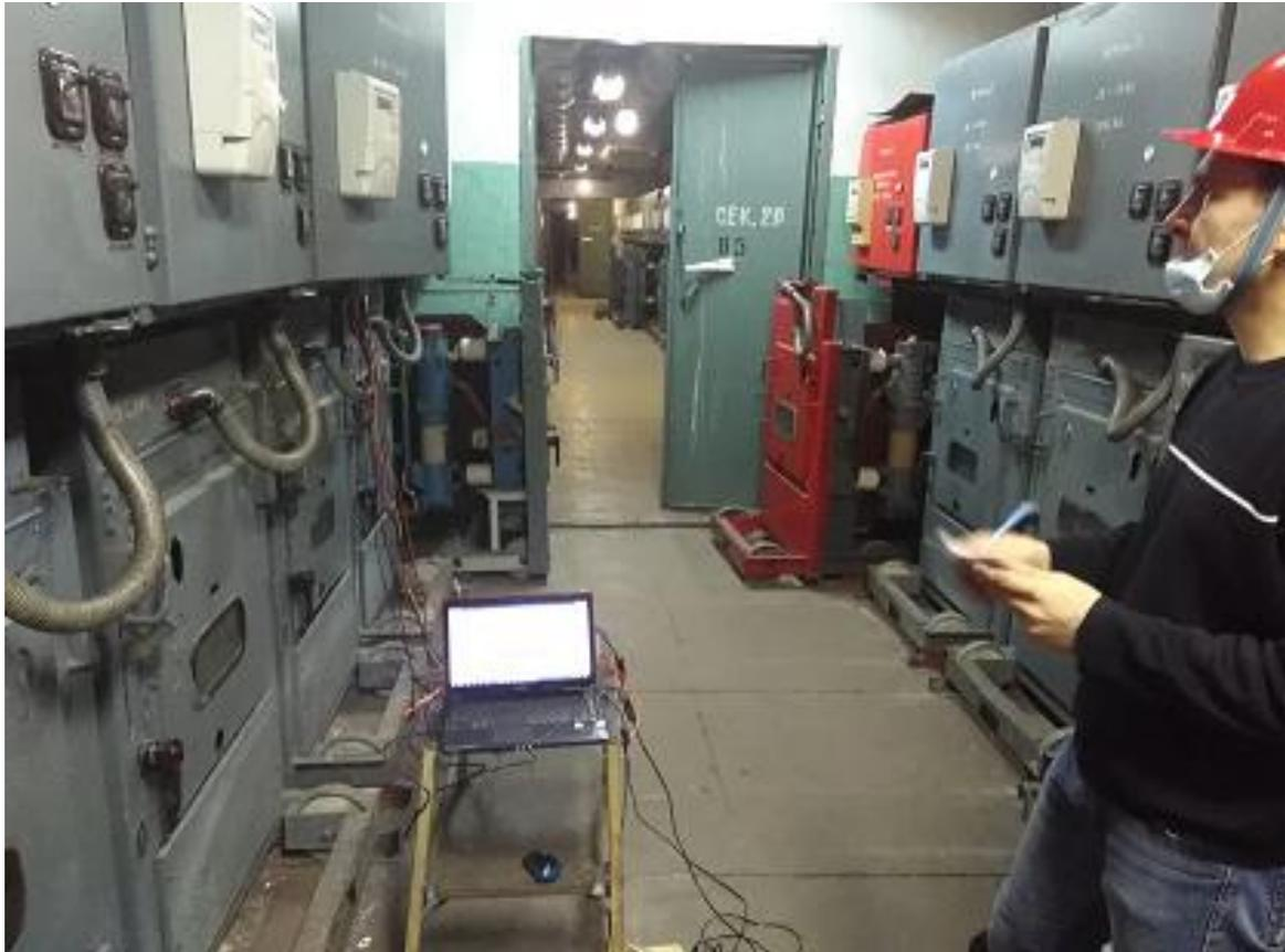
Рис. 4.25. Процесс регистрации сигнала тока статора АД типа ДАМСО-15-12-8 на ТЭЦ-2 города Иваново
