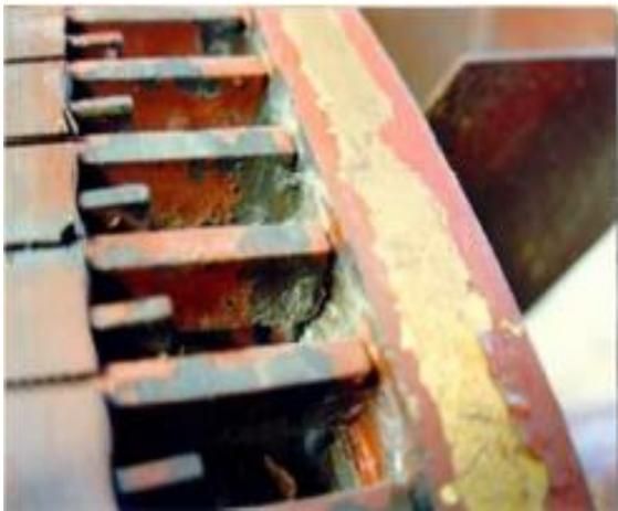
Рис. 1.7. Обрыв стержней ОР высоковольтного АД [17]
