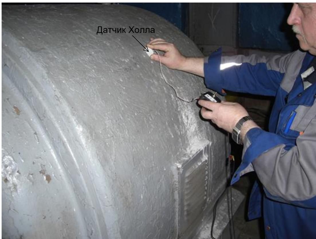
Рис. 4.20. Процесс регистрации сигнала радиальной составляющей ВМП на корпусе двигателя типа ДАМСО-15-12-8 на ТЭЦ-2 города Иваново
