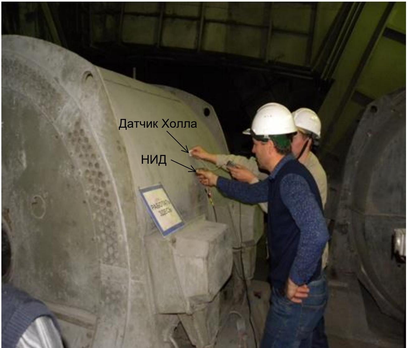
Рис. 4.18. Процесс регистрации сигнала радиальной составляющей ВМП на корпусе двигателя типа ДАЗО2-17-44-8/10У1 на ТЭЦ-3 города Иваново (расположение датчиков)
