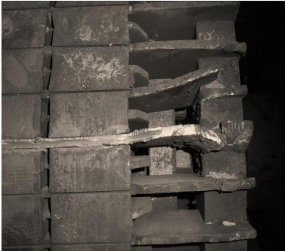
Рис. 1.1. Обрыв стержней ОР АД типа АНЗ-4-16-45-10
