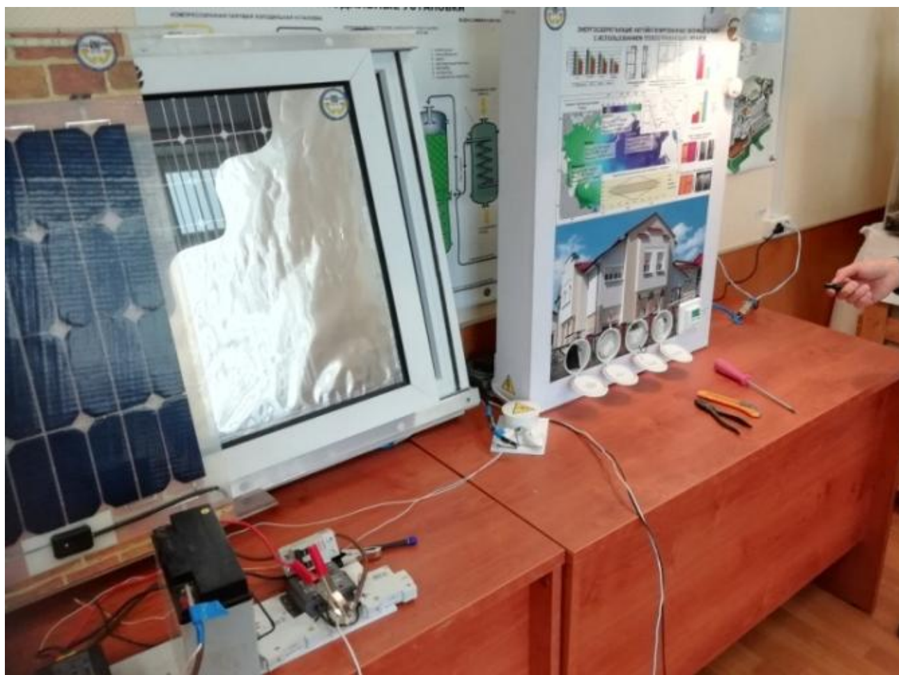
Рисунок 2.19 – Внешний вид разработанного экспериментального образца автоматизированной системы управления работой теплоотражающего экрана с солнечной фотоэлектрической батареей для оконного блока
