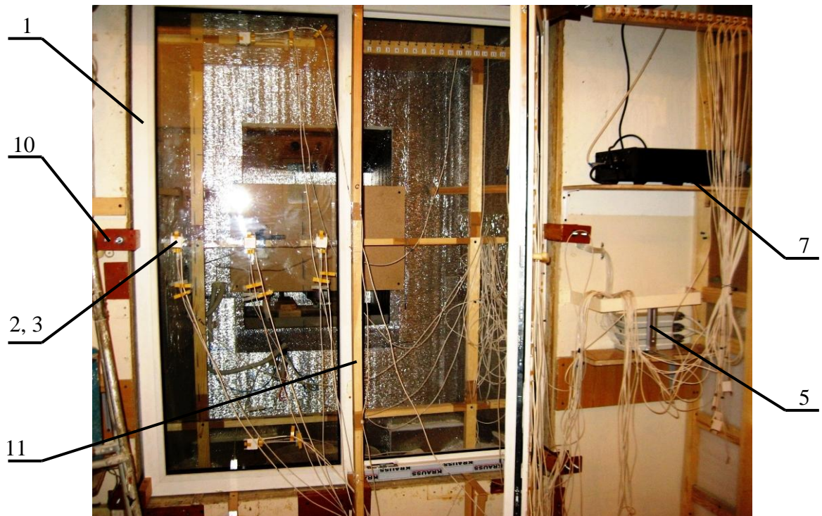
Рисунок 3.9 – Схема СИСТОК-IV на базе ИТ-2-96: 1 – оконный блок; 2 – спай термопары на поверхности материала; 3 – термомер; 4 – спай термопары для измерения температуры воздуха в отделениях; 5 – устройство компенсации УК-4; 6 – соединительный кабель; 7 – ИТ-2-96; 8 – ЭВМ; 9 – принтер; 10 – планки крепления окна; 11 – передвижная планка для размещения термопар
