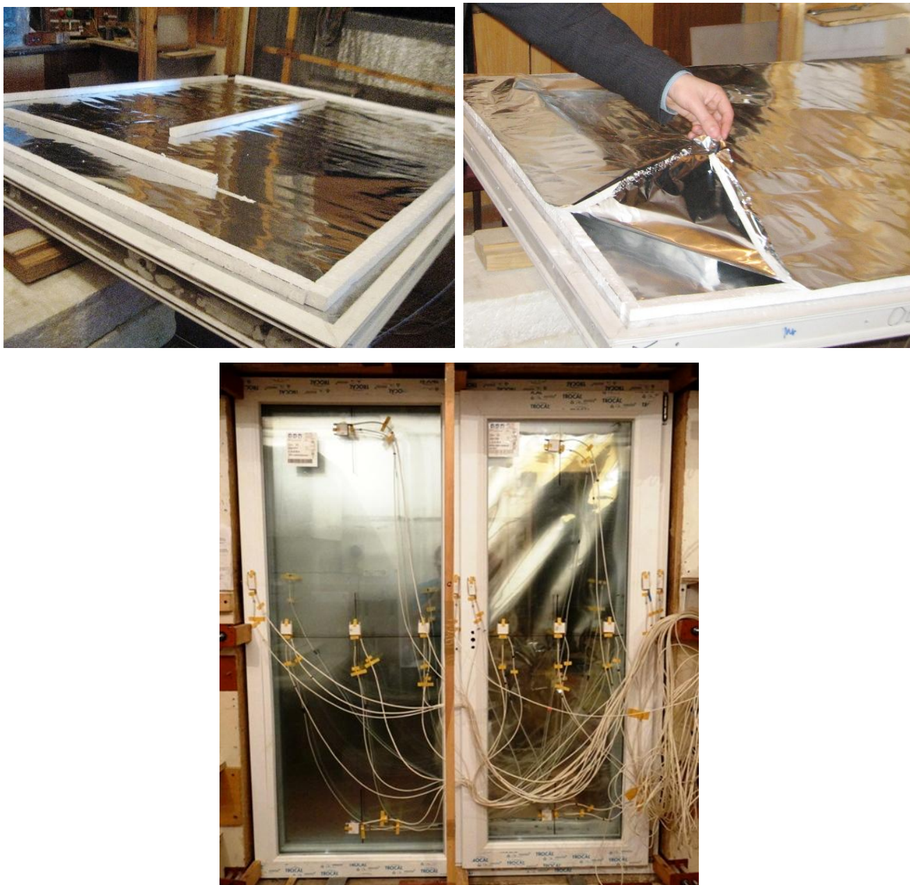
Рисунок 3.14 – Размещение двух экранов сплошного типа из алюминиевой фольги на оконный блок со стороны холодного отделения камеры при помощи дистанционной рамки из полистирола
