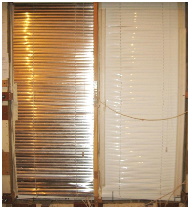
Рисунок 3.12 – Размещение эмалированных и очищенных от лакокрасочного покрытия жалюзи на оконном блоке со стороны теплого отделения климатической камеры
