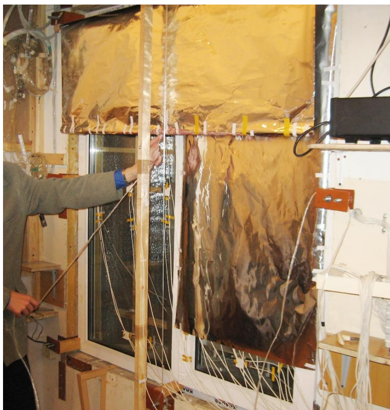
Рисунок 3. 25 – Опускание рулонного теплоотражающего металлического экрана
