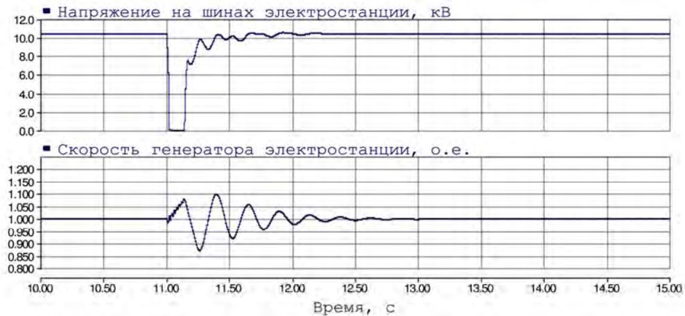
Рисунок В.8 – Графики переходных процессов при близком трёхфазном металлическом КЗ (электростанция в мощной сети;  $T_j = 1$  с, система самовозбуждения; нагрузка на шинах электростанции – отключена);  $t_{КЗ} = 0,14$  с. Устойчивость генераторов электростанции сохраняется
