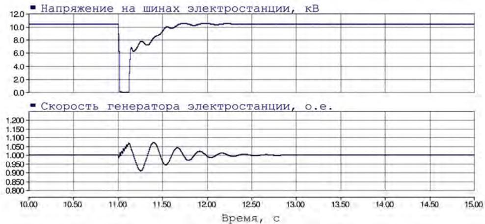
Рисунок В.12 – Графики переходных процессов при близком трёхфазном металлическом КЗ (электростанция в мощной сети;  $T_j = 1$  с, система самовозбуждения; нагрузка на шинах электростанции – включена; доля двигателей в составе нагрузки – 70%);  $t_{КЗ} = 0,12$  с .
