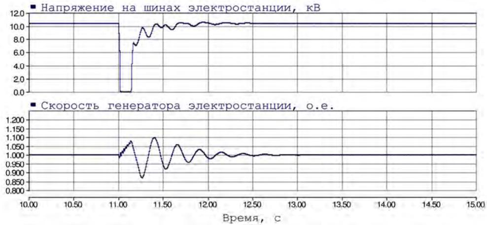
Рисунок В.10 – Графики переходных процессов при близком трёхфазном металлическом КЗ (электростанция в мощной сети;  $T_j = 1$  с, система самовозбуждения; нагрузка на шинах электростанции – включена; доля двигателей в составе нагрузки – 0%);  $t_{КЗ} = 0,14$  с .
