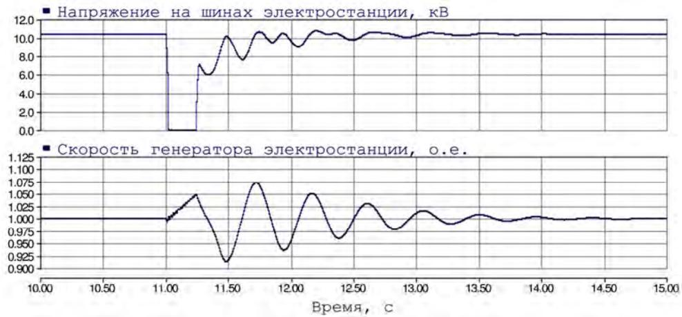
Рисунок В.16 – Графики переходных процессов при близком трёхфазном металлическом КЗ (электростанция в мощной сети;  $T_j = 3$  с, система независимого возбуждения; нагрузка на шинах электростанции – включена; доля двигателей в составе нагрузки – 0%);  $t_{КЗ} = 0,24$  с. Устойчивость генераторов электростанции сохраняется
