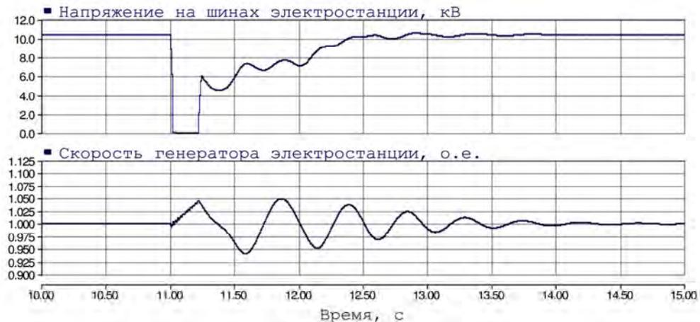
Рисунок В.24 – Графики переходных процессов при близком трёхфазном металлическом КЗ (электростанция в мощной сети;  $T_j = 3$  с, система самовозбуждения; нагрузка на шинах электростанции – включена; доля двигателей в составе нагрузки – 70%);  $t_{КЗ} = 0,22$  с. Устойчивость генераторов электростанции сохраняется
