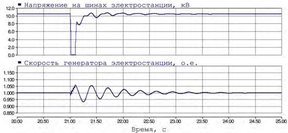
Рисунок В.44 – Графики переходных процессов при близком трёхфазном металлическом КЗ (электростанция в слабой сети;  $T_j = 1 \text{ с}$ , система самовозбуждения; нагрузка на шинах электростанции – отключена);  $t_{K3} = 0,10 \text{ с}$ . Устойчивость генераторов электростанции сохраняется
