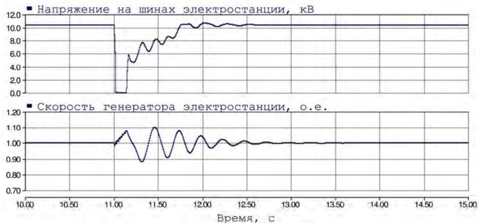
Рисунок В.6 – Графики переходных процессов при близком трёхфазном металлическом КЗ (электростанция в мощной сети;  $T_j = 1$  с, система независимого возбуждения; нагрузка на шинах электростанции – включена; доля двигателей в составе нагрузки – 70%);  $t_{КЗ} = 0,14$  с .
