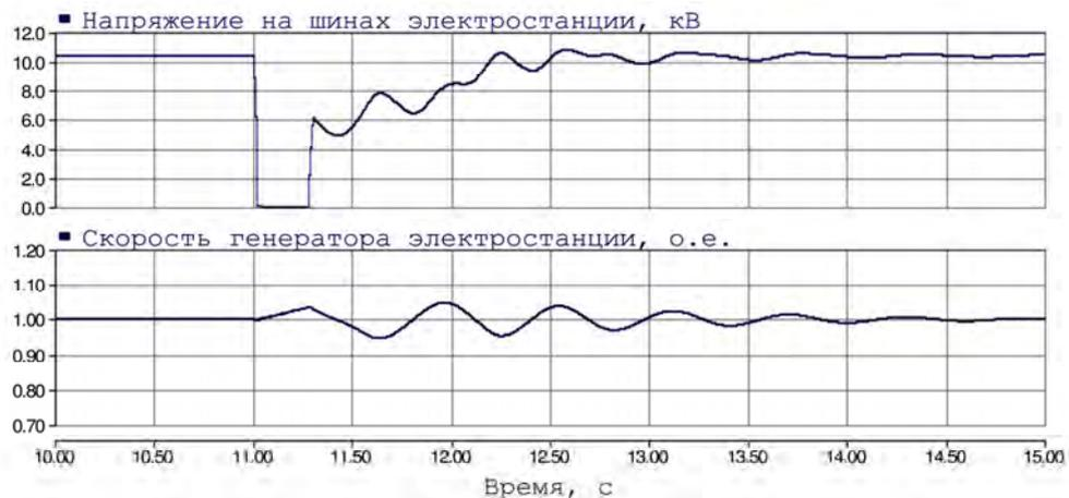
Рисунок В.30 – Графики переходных процессов при близком трёхфазном металлическом КЗ (электростанция в мощной сети;  $T_j = 5$  с, система независимого возбуждения; нагрузка на шинах электростанции – включена; доля двигателей в составе нагрузки – 70%);  $t_{КЗ} = 0,28$  с. Устойчивость генераторов электростанции сохраняется
