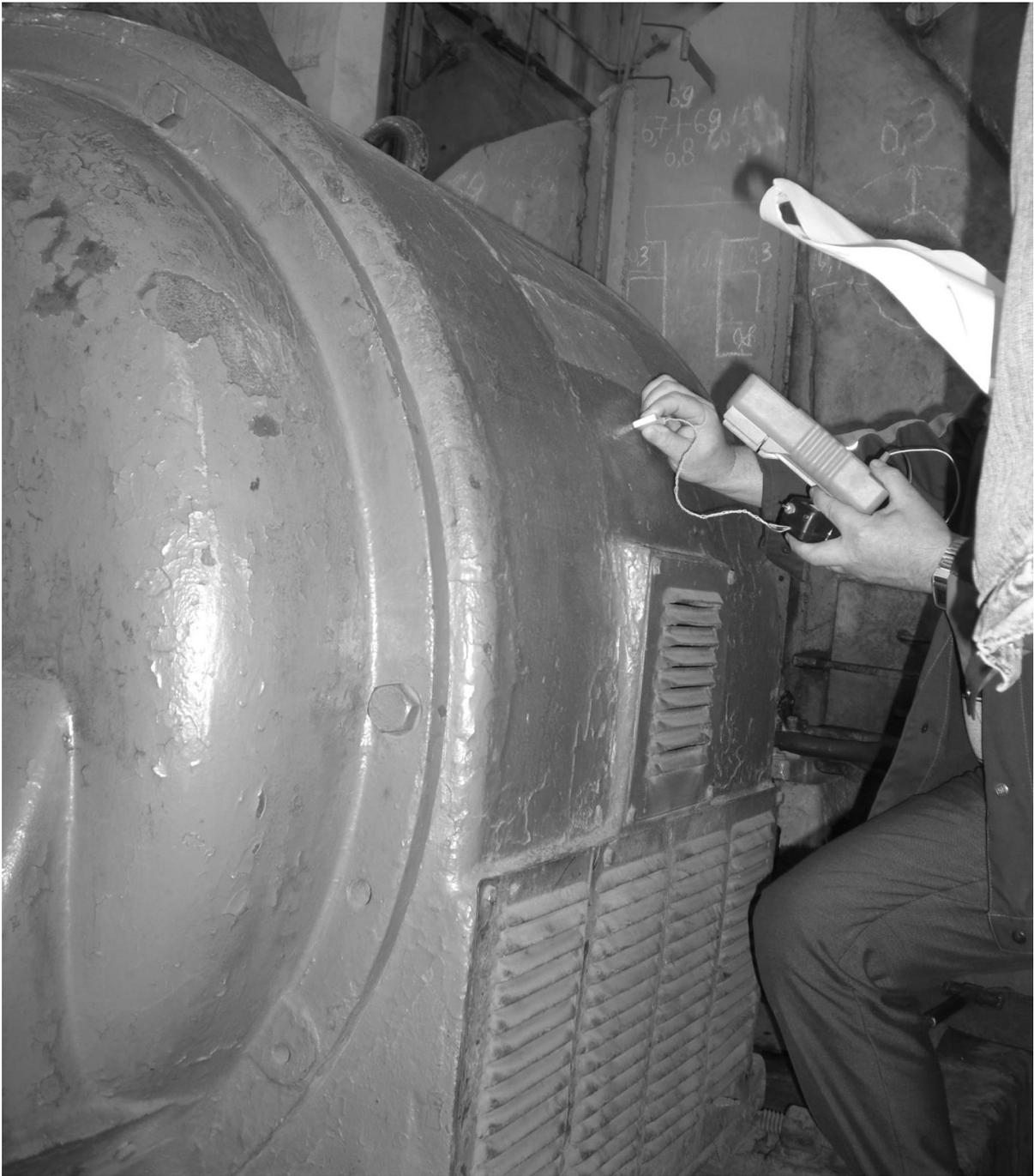
Рис. 4.7. Регистрация ВМП на корпусе двигателя ДАМСО-15-12-8 дымососа ИвТЭЦ-2
