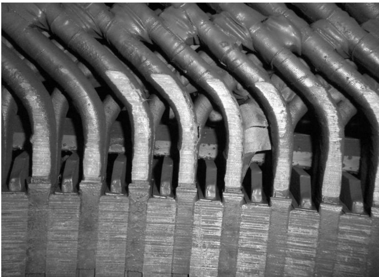
Рис.1.2. Повреждение обмотки статора двигателя АНЗ-4-16-45-10 из-за обрыва стержней обмотки ротора
