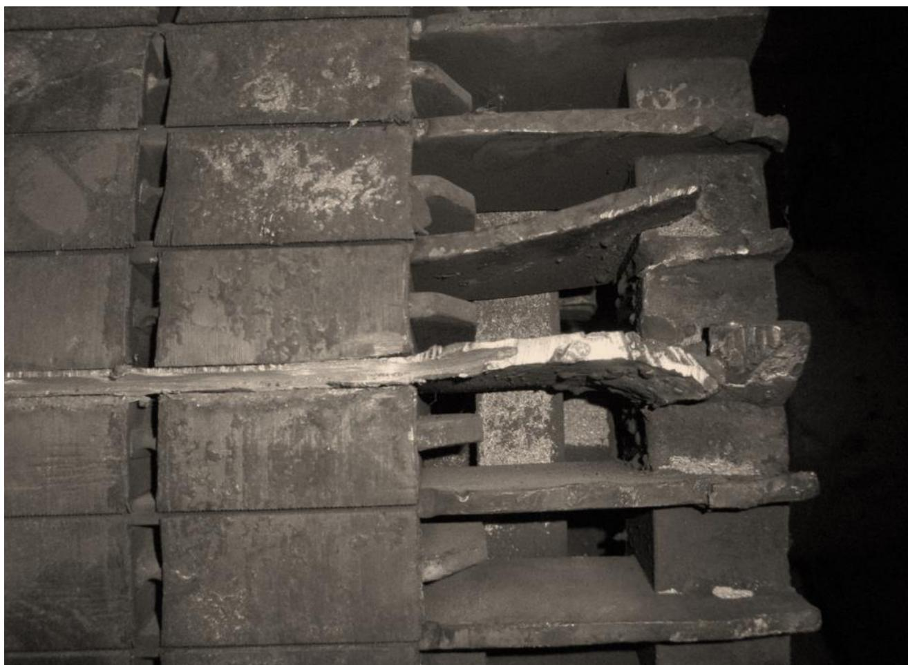
Рис. 1.1. Обрыв стержней обмотки ротора двигателя АНЗ-4-16-45-10
