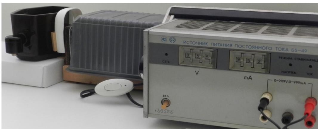
Рис. 4.5. Общий вид предложенной системы перемешивания масла в стандартной ячейке
