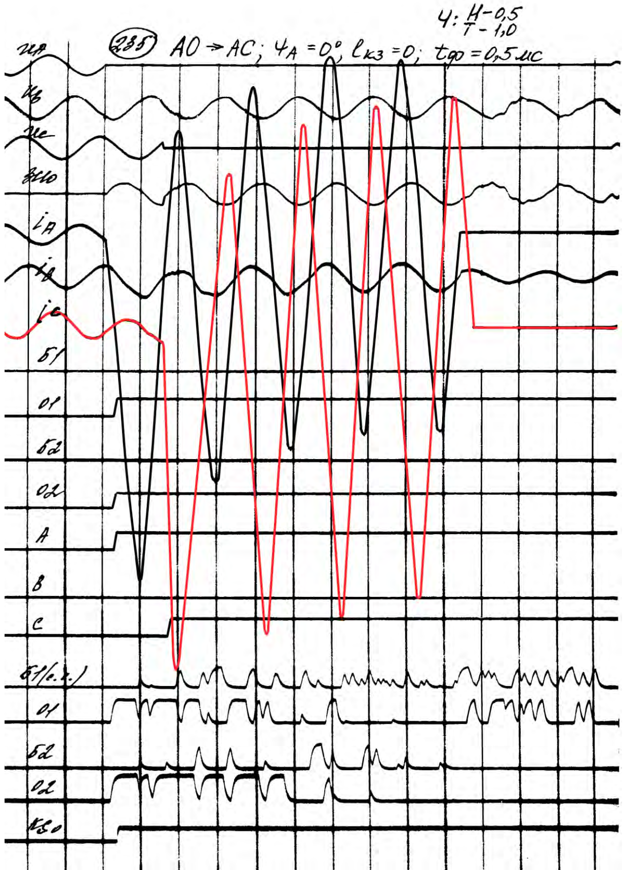
Рис. 1.59. Действие избирателя поврежденных фаз при переходе близких однофазных КЗ в двухфазные КЗ при \psi_A = 0^\circ , положениях по Ч по току 1,0 и по напряжению 0,5 и t_\phi = 0,5 \text{ мс}
