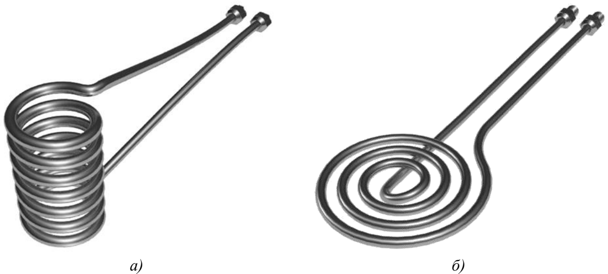
Рис. 1.2. Формы индукторов для закалки цилиндрических (а) и плоских поверхностей (б)
