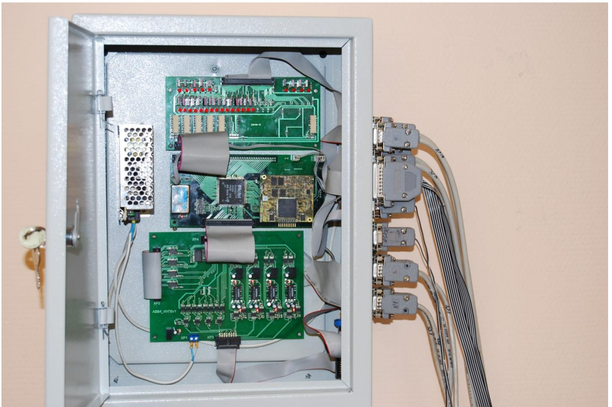
Рис. 5.3. Общий вид экспериментального стенда (а), преобразователя ТПЕ (б) и цифровой микропроцессорной системы управления (в)
