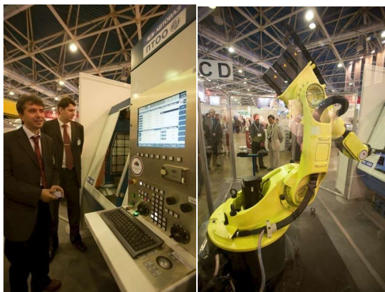
Рис. 1.14. Робот ТУР-30 в составе роботизированного комплекса с вертикально-фрезерным станком МС-400
