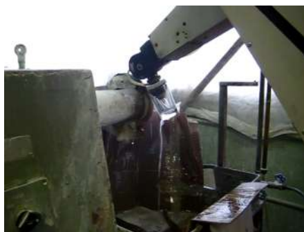
Рис. 1.4. Обработка изделий на станке с использованием манипуляционного робота на стекольном заводе в г. Гусь-Хрустальный
