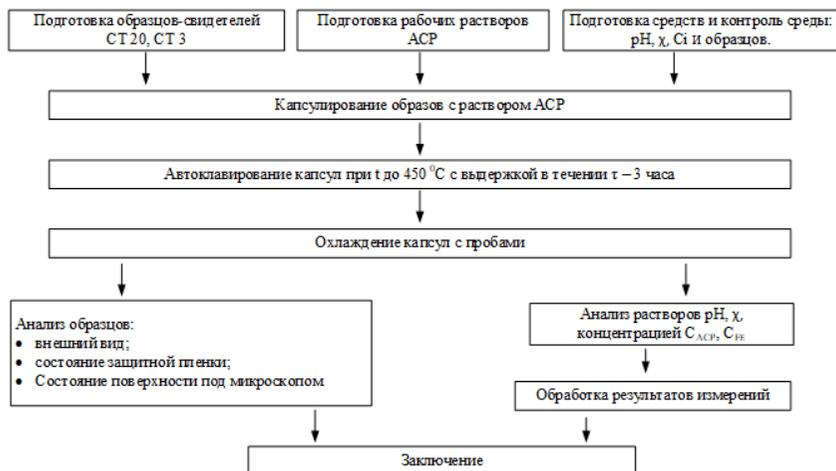
Рисунок 1. Схема организации лабораторных исследований состояния поверхностей образцов-свидетелей и термической стойкости аминоксодержащих реагентов
