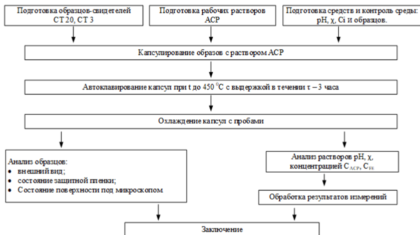
Рисунок 1. Схема организации лабораторных исследований состояния поверхностей образцов-свидетелей и термической стойкости аминоксодержащих реагентов
