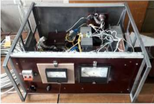
Рис. 10. Внешний вид транзисторного преобразователя напряжения мощностью 7 кВт
