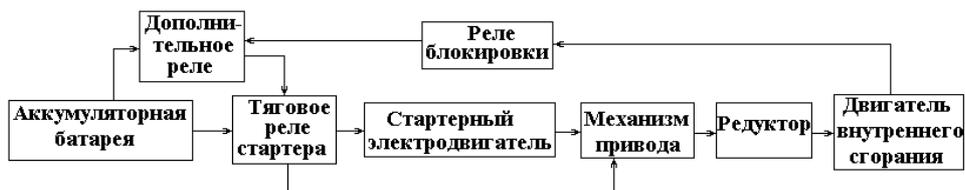
Рис. 1. Структурная схема ЭСП ДВС
