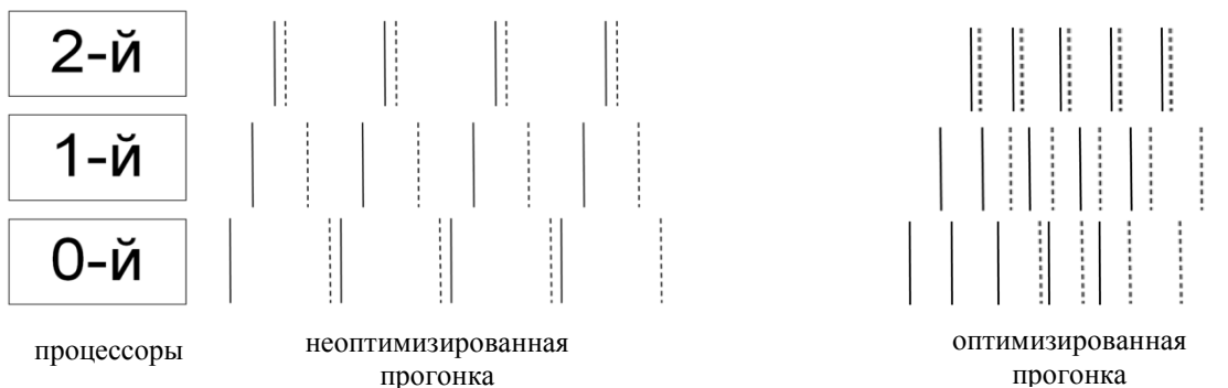
Рис. 2. Сокращение времени вычисления прогоночных коэффициентов при использовании алгоритма двухкаскадного конвейера
