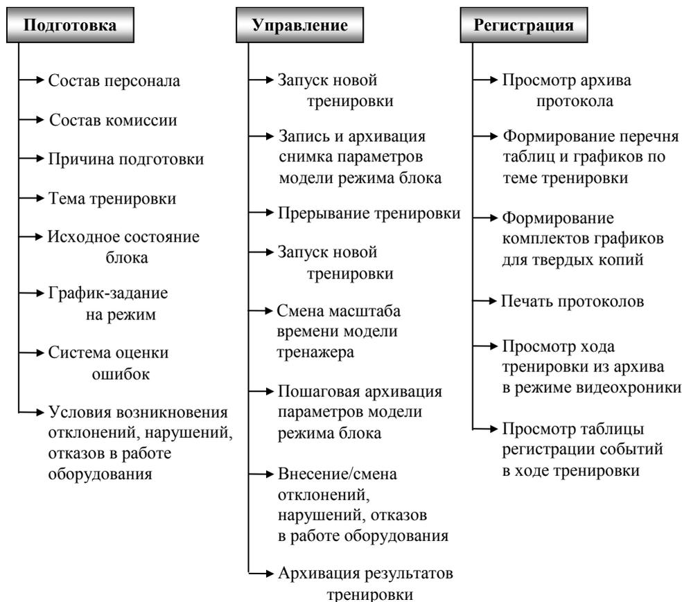
Рис. 6. Функциональные возможности выделенного АРМа инструктора тренировки
