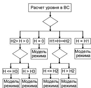
Рис. 4. Блок-схема модели встроенного сепаратора
