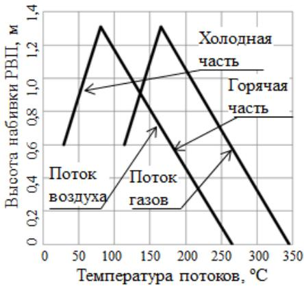
**Рис. 13.** Распределение температур потоков в двухпоточном двухходовом РВП
