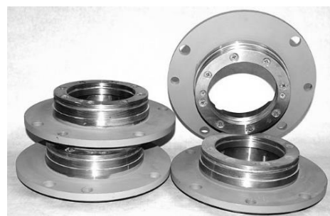
Рис. 1.14. Герметизация рудничного электродвигателя ЭКВК 4-220 с применением МЖГ и манжетных уплотнений
