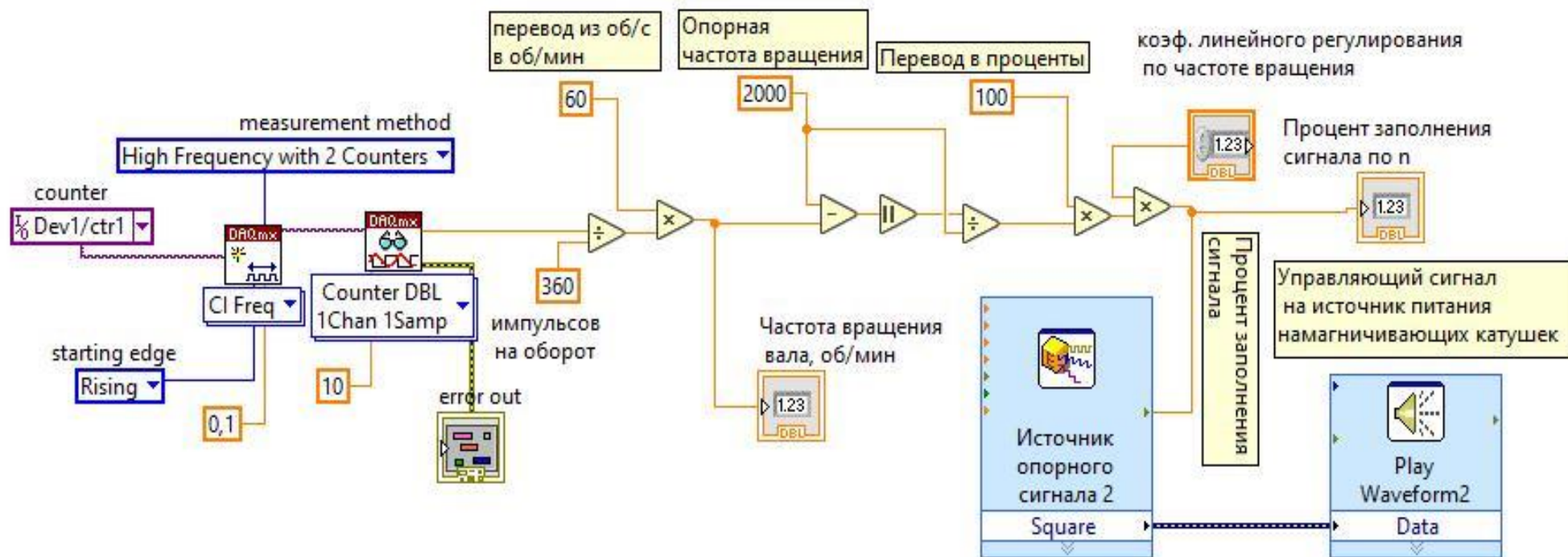
Рис. 3.11. Имитационная модель системы регулирования напряжения на намагничивающих катушках МЖГ по частоте вращения вала в программном комплексе LabVIEW
